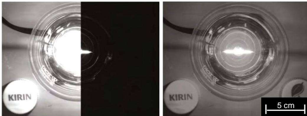
Abb. 3.8: Aufnahme Kerzenlicht bei geringem Dynamikumfang und unterschiedlichen Belichtungszeiten (links) sowie hohem Dynamikumfang (rechts) [Ste18]
