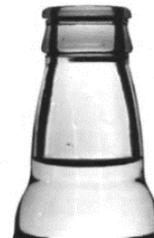
Diffuses Durchlicht zur Erkennung des Füllstandes
